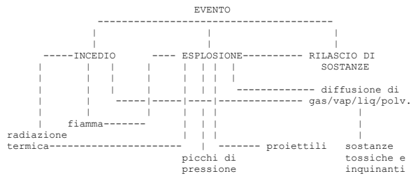
FIGURA 2 - Sviluppo dei fenomeni incendio, esplosione e rilascio di sostanze tossiche inquinanti.
